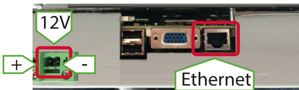
Collegare l'alimentazione 12Vdc e il cavo ethernet come in gura. Agganciare ATMOSFERA alla scatola da incasso attraverso le 4 viti in dotazione.
